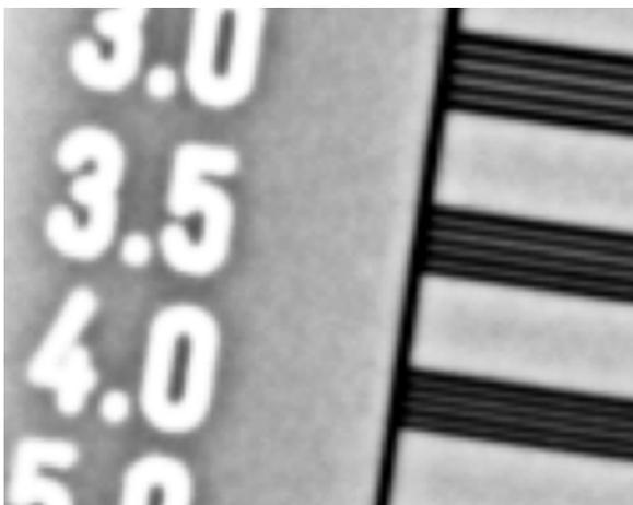
El primer detector que cambia entre alta resolución (100  $\mu$ ) y alto rango dinámico (200  $\mu$ ) ofrece detalles excepcionales de estructuras pequeñas y mejora la nitidez y el contraste. La alta definición es perfecta para extremidades y hombros, mientras que el alto rango dinámico proporciona una amplia gama de grises y una imagen suave, ideal para detectar sutilezas en el tejido blando.
